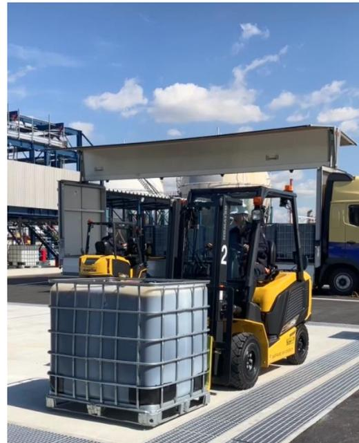
ウィング車によるIBCコンテナ搬入
