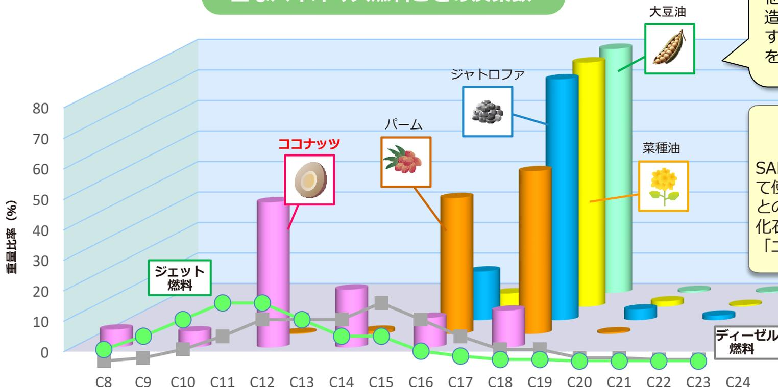
他の植物油は、ディーゼル燃料製造に適しており、ジェット燃料にするためには、CCOに比べ炭素数を減らす必要がある。
