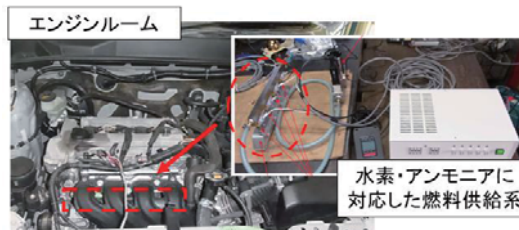
Fig.1 燃料供給系改造状況
