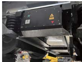
分岐器の車上計測システム開発例 出典: https://dmatolino.it/tunout-crossing-measurement-system/
