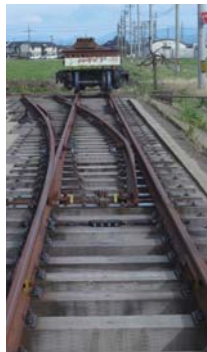
分岐器の車上計測システム開発例 出典: https://dmatolino.it/tunout-crossing-measurement-system/
