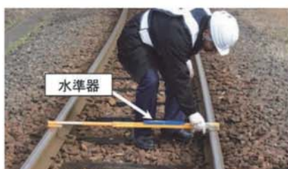
図3 静的水準変位検測の様子
