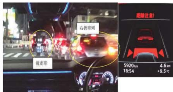
図4 自動運転レベル2運転支援システムの調査 (前走者や右折車両に対する検知と反応を調査)
