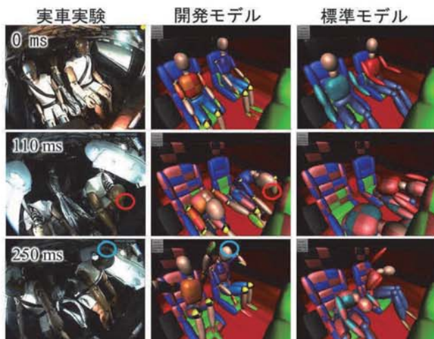
図 3 フルラップ前面衝突の後席乗員挙動
