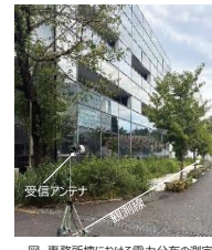
図 駅事務所における電力分布の測定
