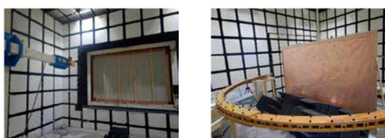
(a) 透過特性 (b) 反射特性 図 2.3.2.1 自由空間法による建材の透過反射係数の測定系
