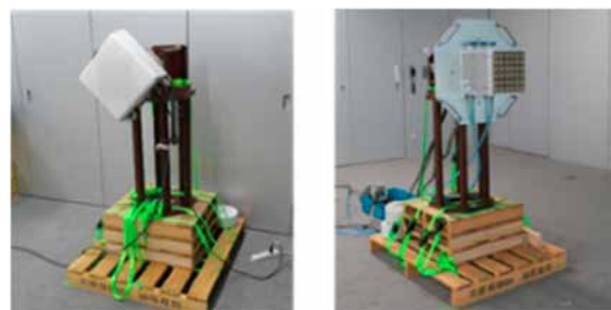
(a) 16素子送電装置 (b) 36素子送電装置
