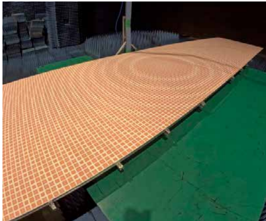
図 31 9\text{ m}^2 織物膜アンテナ 完成品
