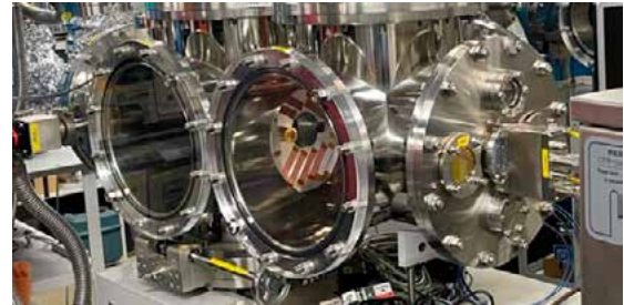
図 36 原子状酸素照射試験設備
