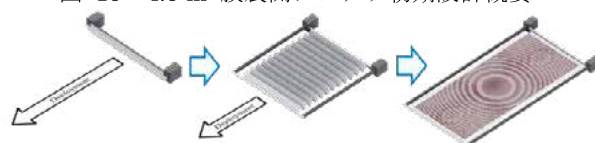
図 16 4.5 m 2 膜展開アンテナ展開方法
