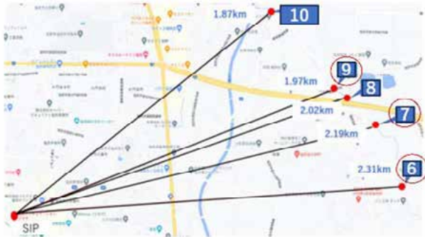
(b) 河川（鋳物師川）沿いの集約局とセンサ端末配置
